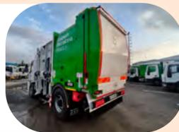
**Recolector compactador eléctrico** de carga trasera con carrocería de doble compartimento, 10 m<sup>3</sup> de capacidad y reducidas dimensiones. Trabaja en modo eléctrico en la recolección y dispone de autorrecarga con un motor de gas natural comprimido (GNC).
