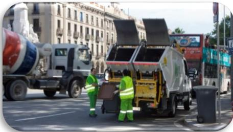
Recogida comercial mediante Vehículo bi-compartmentado
