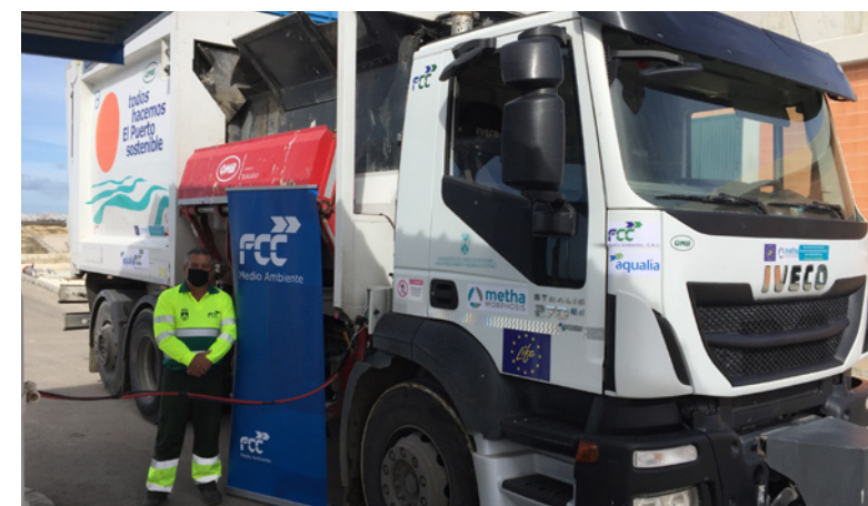
Ensayos técnicos de uso del biometano como combustible en vehículo pesado de recogida para proyecto METHAmorphosis.
