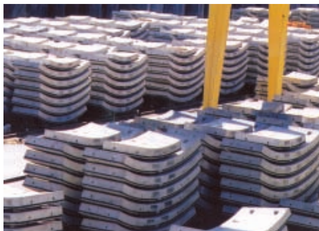
Dovelas prefabricadas para el revestimiento de túneles
