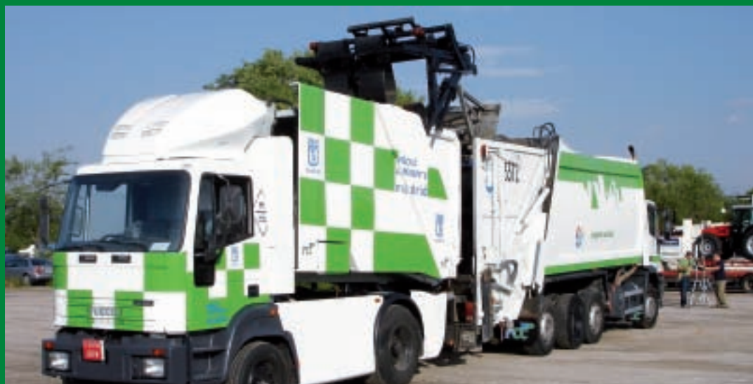
Vehículo recolector-compactador híbrido
