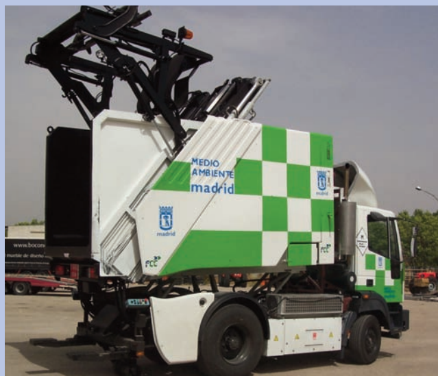
Vehículo híbrido-eléctrico recolector
