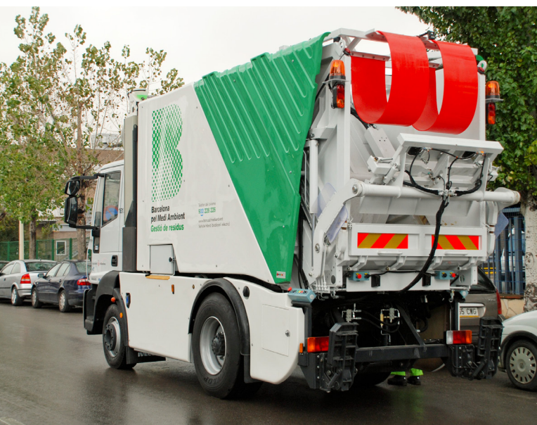
Vehículo eléctrico-híbrido para la recogida de residuos sólidos urbanos, Barcelona.
